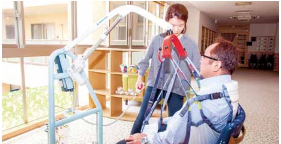
晋栄福祉会が導入した移乗リフト。最大120kgのひとまで吊り上げることが可能だ
